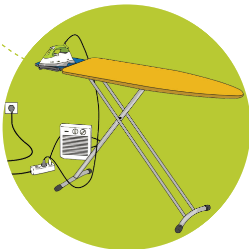
Figura 27: vários equipamentos ligados numa extensão podem dar origem a uma sobrecarga no circuito da tomada
